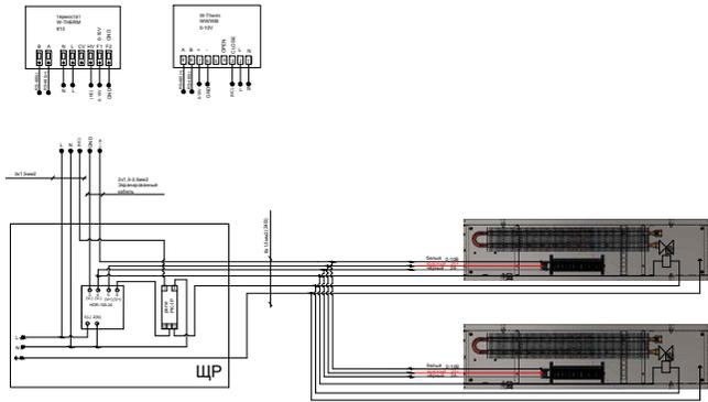
Схема подключения HDR-100-24
